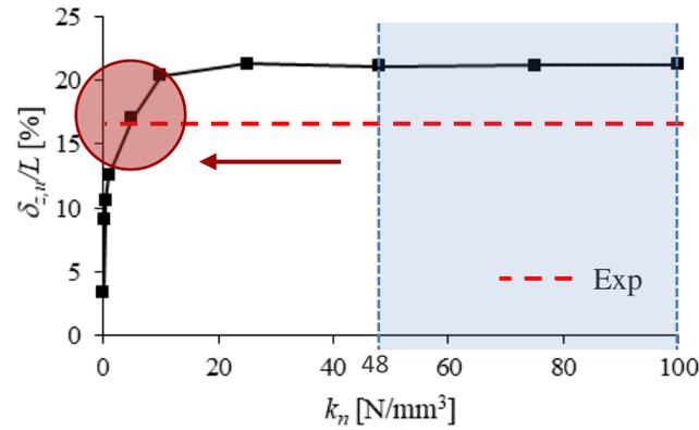
Collapse displacement  $\delta_{z,u}/L$  vs  $k_n$
